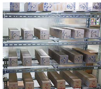
供試体養生状況
