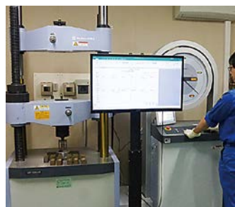
モルタル圧縮強度試験
