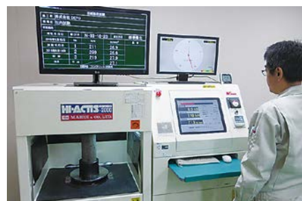
圧縮強度試験
