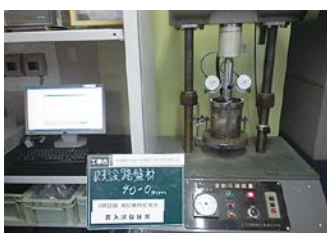
CBR 貫入試験
