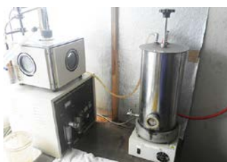
アスファルト回収試験
